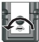
Drehen Sie den Schlüssel eine halbe Umdrehung nach links (180 Grad gegen den Uhrzeigersinn).
