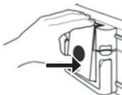
Drücken Sie bei heruntergedrücktem Riegel die Unterseite des Riegels nach innen.
