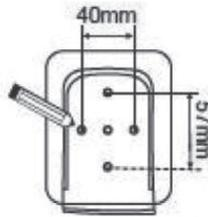
3. Bohren Sie die Bohrlöcher.
