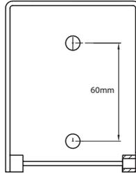
3. Bohren Sie die Bohrlöcher.
